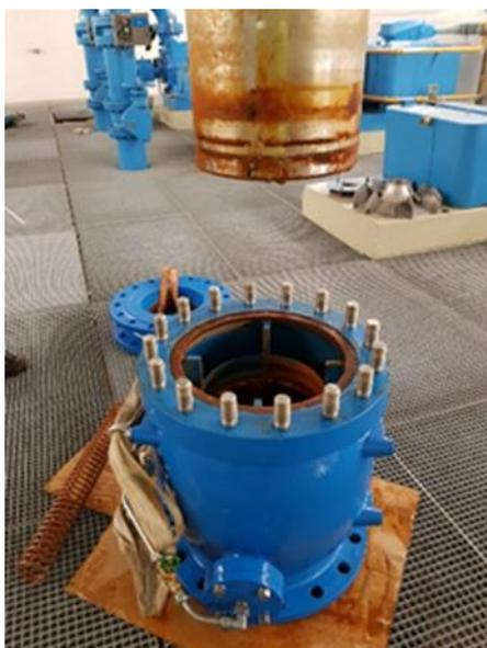
Abbildung 5: Ringkolbenrückschlagventil
